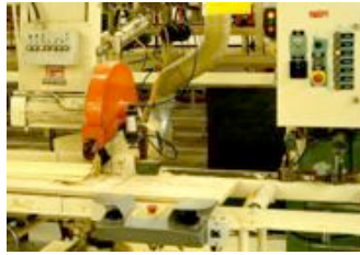
Parallellkapsåg med maskinell matning av sågklingan
