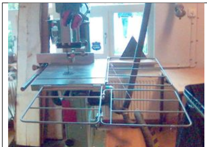
Distansskydd på bandsåg
