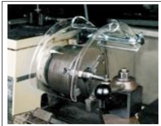
Ställbart skydd till svarvchuck med spännbackar
